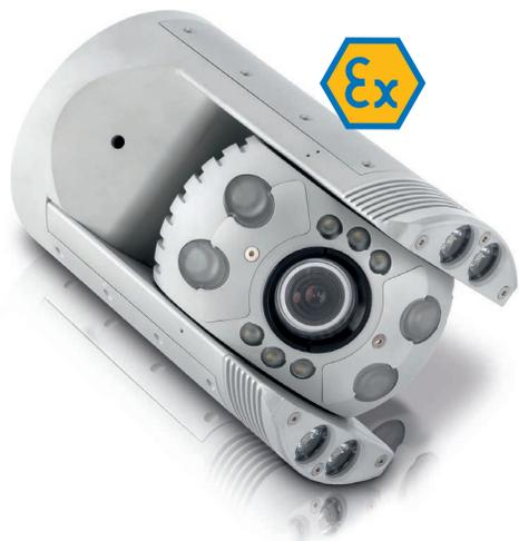
ARGUS 5 представляет собой видеокамеру с функцией наклона, поворота и вращения, которая нажатием кнопки может быть адаптирована к необходимым специальным условиям. При помощи кнопки предварительного выбора можно настроить поворотный или наклонный режимы. Доступны дополнительные для выбора функциональные возможности, а именно: „направление обзора 45°“, „направление обзора 90°“, „нейтральное положение“, а также автоматическое полнооборотное обследование трубных стыков.
