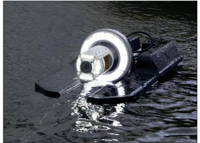
Плавающий модуль предназначен для обследования частично заполненных трубопроводов и разработан специально для российского рынка. Плот может работать практически в любом трубопроводе, диаметром от 400 до 3000 мм, при этом нет необходимости перекрывать или снижать поток воды. Благодаря компактным габаритным размерам 350 мм в ширину и 725 мм в длину, плавающий модуль можно вводить в любой стандартный
