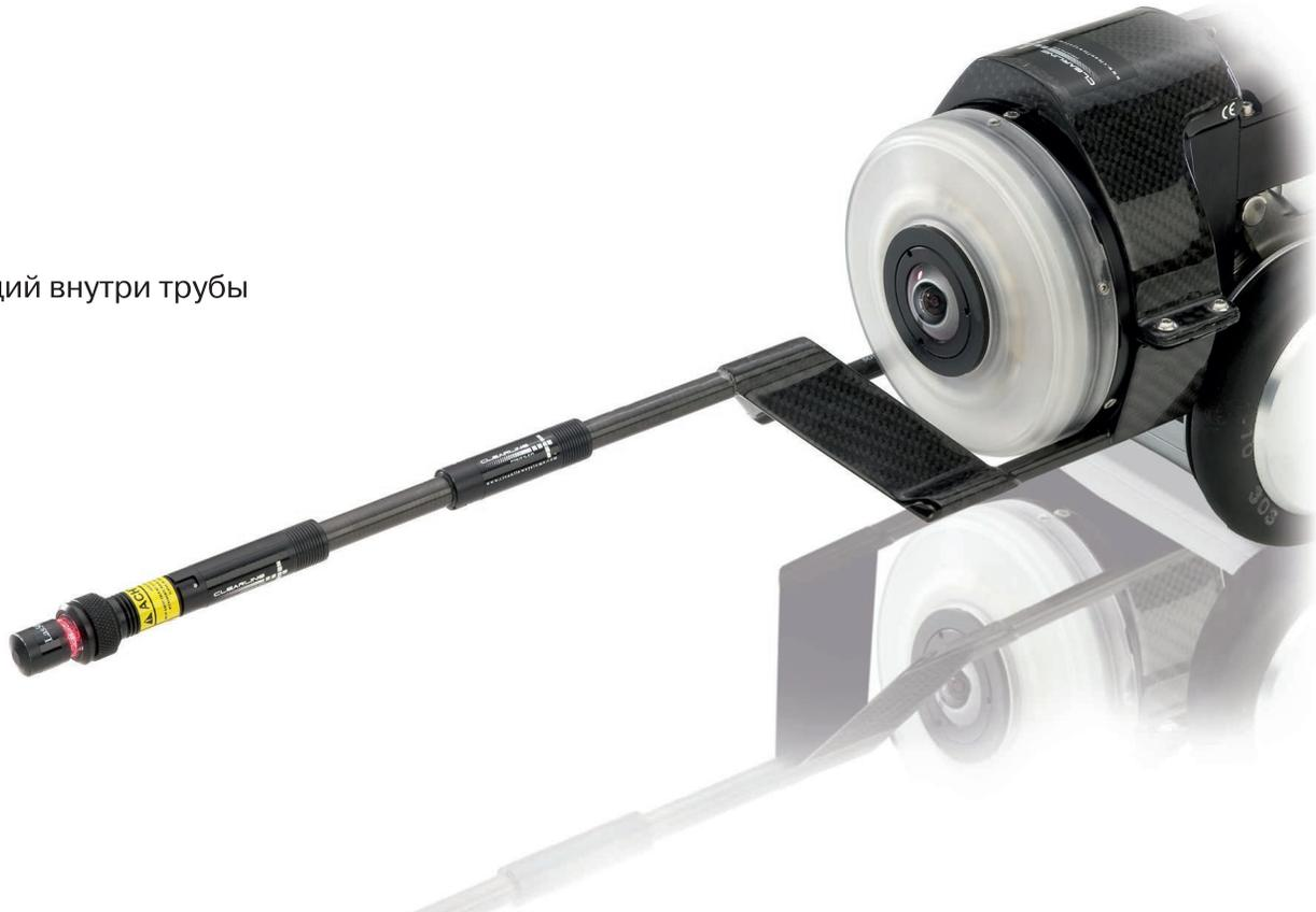
ILP (Laser Profiler) определяет и точно рассчитывает деформации трубопроводов. Замер деформаций производится при помощи лазерного диода, смонтированного на камере для инспектирования канализационных труб (TRITON, PANORAMO, ARGUS 5, ORION, JUNO и ORPHEUS). В зависимости от диаметра трубы и типа камеры используются различные лазерные удлинители и крепления.
