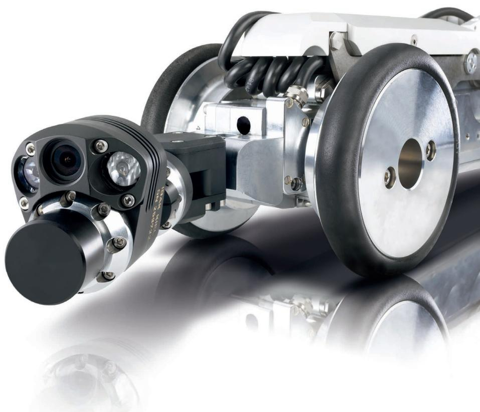
RETRUS представляет собой камеру заднего обзора, которую можно использовать на всех роботах IBAK. Во многих ситуациях RETRUS повышает комфорт и безопасность при движении задним ходом. Преодоленные во время движения вперед проблемные участки, такие как выступающие препятствия, места повреждений и сдвиги повторно распознаются при движении задним ходом, что позволяет оператору соответствующим образом реагировать и избежать повреждения системы.
