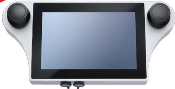
Компактный и удобный Пульт управления в защищенном (IP43) металлическом корпусе снабжен высококонтрастным сенсорным цветным дисплеем 10" с разрешением 1280\*800 точек. Пульт BP100 сконструирован на базе миниатюрного персонального компьютера с предустановленной ОС Win 10 и специализированным программным обеспечением IKAS для управления роботизированным комплексом.
