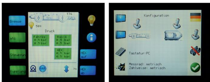
Встроенный в пульт управления сенсорный экран с различными возможностями управления системными компонентами ИВАК.
